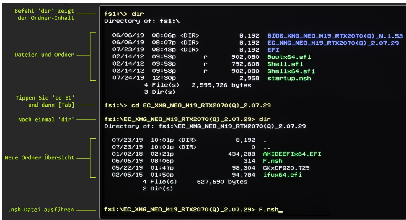
Abb. 6: Navigation der EFI-Shell und Ausführung eines EC-Updates. Namen von Dateien und Ordner sind je nach System und Update unterschiedlich.
